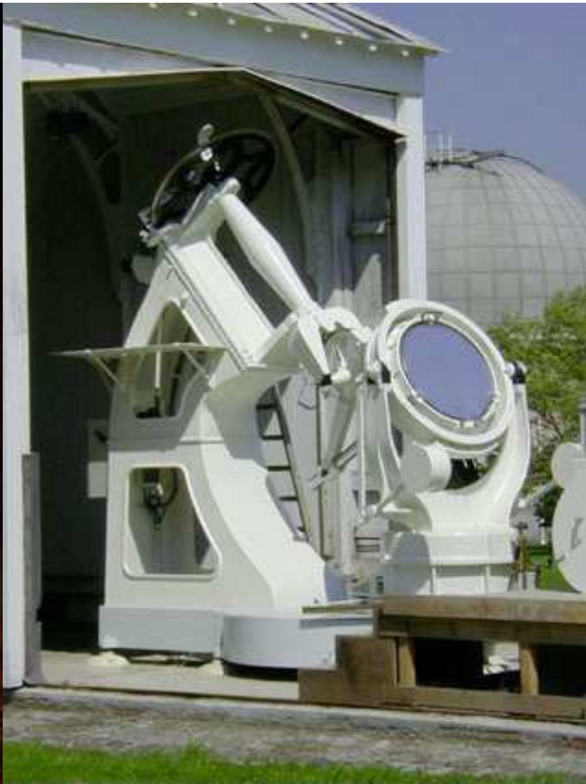
1980 Le Grand Sidérost de Foucault alimente le magnétographe de Meudon, appareil de cartographie des champs magnétiques solaires longitudinaux (J. Rayrole)
